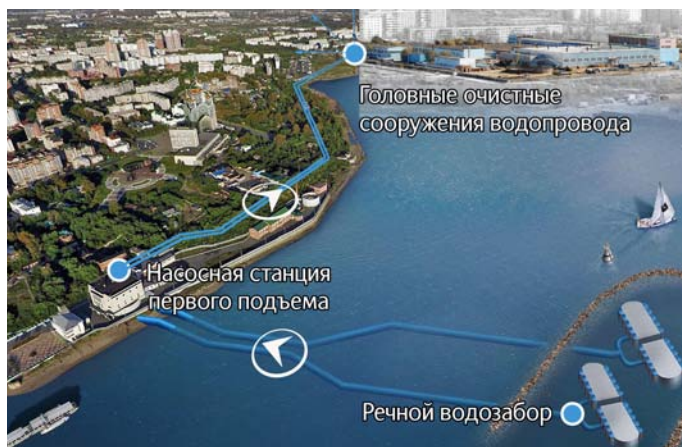
Схема забор и подачи воды на головные очистительные сооружения
